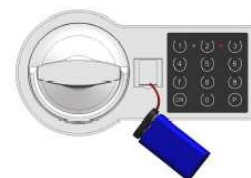
рис. 3. Подключение внешней батареи
